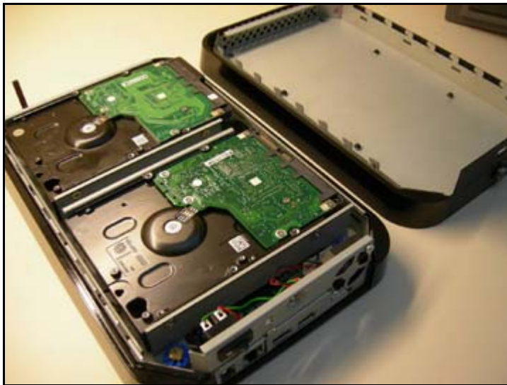
Kuva 126: Levyasema kansi poistettuna
