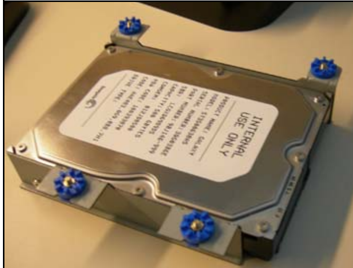
Kuva 132: Korvaava levy-yksikkö, jonka kiinnikkeet ovat paikoillaan
